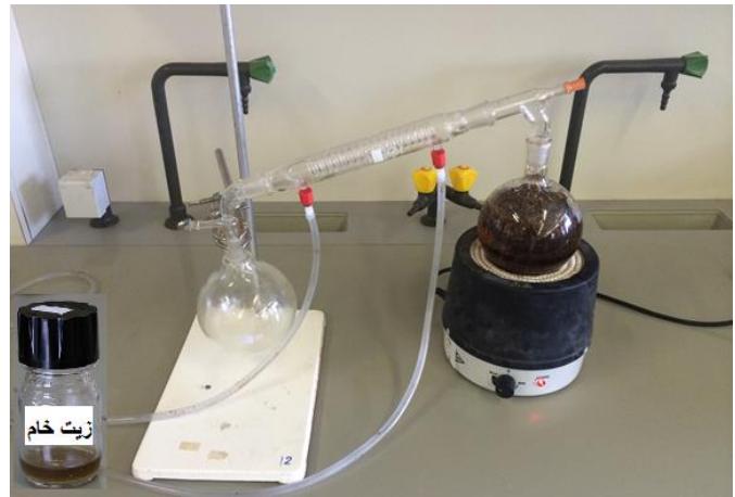
شكل (2): التقطير المائي التقليدي للزيت بواسطة جهاز Clevenger
